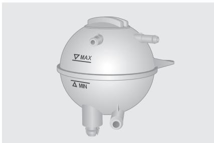
5. Если явных утечек охлаждающей жидкости нет, проверьте ее уровень в расширительном бачке. Если уровень охлаждающей жидкости находится на отметке MIN или ниже ее, долейте охлаждающей жидкости, чтобы ее уровень находился между метками MIN и MAX. Используйте только охлаждающую жидкость, рекомендованную компанией Chery.
