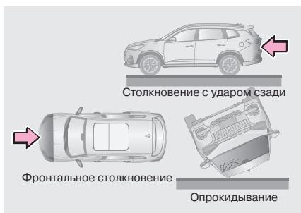
Как правило, боковые подушки безопасности и оконные шторки безопасности не срабатывают при фронтальном столкновении или столкновении с ударом сзади, при опрокидывании автомобиля или при столкновении с ударом сбоку на малой скорости.
