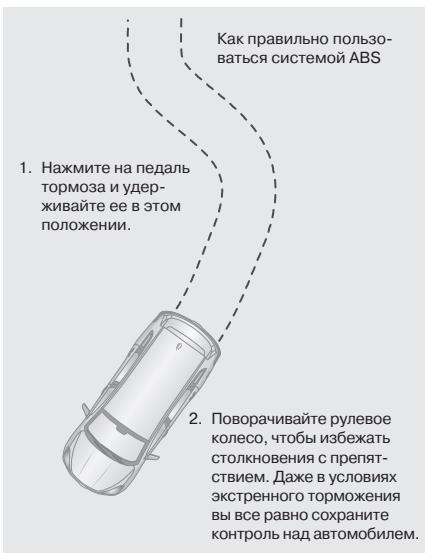
Антиблокировочная тормозная система (ABS) немедленно срабатывает при резком торможении; при этом сохраняются тормозные характеристики и управляемость автомобиля. При достаточном расстоянии до препятствия вы сможете обогнать его.
