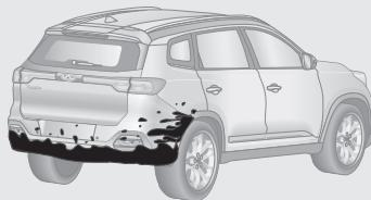
Если поверхность ультразвуковых датчиков покрыта снегом или грязью, датчики не могут обнаружить препятствия.
