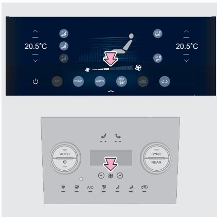
Задать нужную скорость вращения вентилятора можно кнопками на панели управления системой кондиционирования воздуха или сенсорными кнопками на дисплее.
