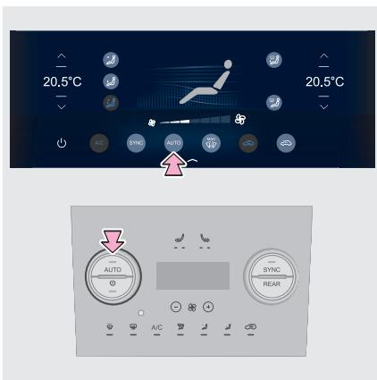
Выключить режим AUTO можно кнопкой AUTO на панели управления системой кондиционирования воздуха или соответствующей сенсорной кнопкой ( ) на дисплее. Если при включенном режиме AUTO нажать кнопку включения системы кондиционирования воздуха, кнопку увеличения/уменьшения скорости вращения вентилятора, изменить режим распределения воздуха или установить регулятор температуры в положение максимального охлаждения или максимального нагрева, режим AUTO выключится автоматически.
