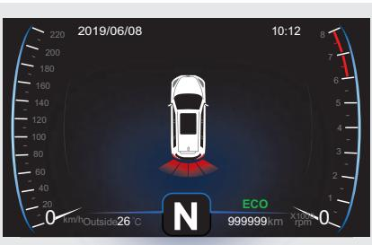
После пуска двигателя и включения передачи заднего хода на информационный дисплей выводится информация системы помощи при парковке (для получения дополнительной информации см. «4-10. Система помощи при парковке»).
