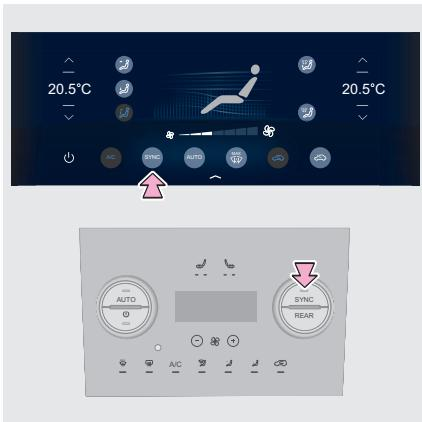
Переключение однозонного/двуихзонного режима системы кондиционирования воздуха осуществляется соответствующей кнопкой на панели управления системой кондиционирования воздуха или сенсорной кнопками на дисплее.
