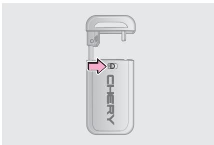
Чтобы воспользоваться механическим ключом, нажмите на кнопку фиксатора на обратной стороне пульта дистанционного управления, достаньте ключ. Закончив пользоваться механическим ключом, вставьте его обратно в корпус пульта дистанционного управления для удобства пользования им и во избежание его утери (для получения дополнительной информации см. «6-9 Механизм запирания двери»).
