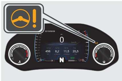
После отсоединения и последующего подсоединения аккумуляторной батареи начинает мигать желтый сигнализатор неисправности электрического усилителя рулевого управления ! Это свидетельствует о том, что идет инициализация EPS. Поверните рулевое колесо влево или вправо, чтобы сбросить показания датчика угла поворота рулевого колеса. После этого желтый сигнализатор погаснет.
