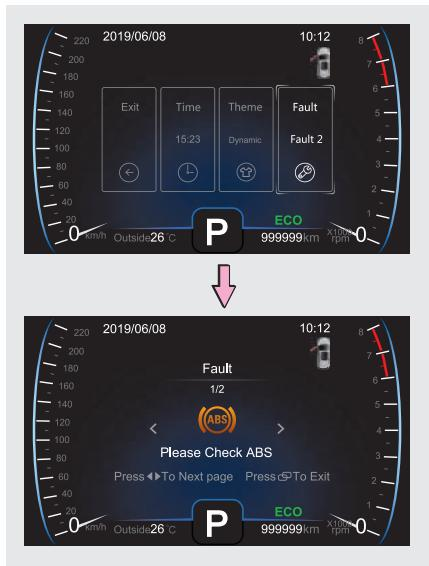
Настроить функцию предупреждения о неисправности можно с помощью кнопок на рулевом колесе.
