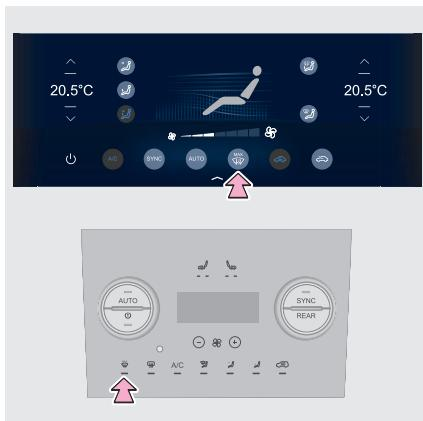
Включить режим обдува и обогрева ветрового стекла можно соответствующей кнопкой на панели управления системой кондиционирования воздуха или сенсорной кнопкой на дисплее.
