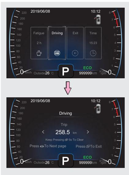
Сбросить показания счетчика пробега за поездку можно с помощью кнопок на рулевом колесе.
