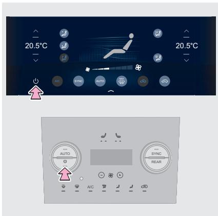
Выключить систему кондиционирования воздуха можно соответствующей кнопкой на панели управления системой кондиционирования воздуха или сенсорной кнопкой
