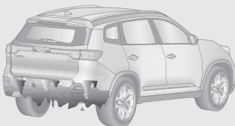
Если капли воды попали на поверхность ультразвуковых датчиков и замерзли, датчики не могут обнаружить препятствия.
