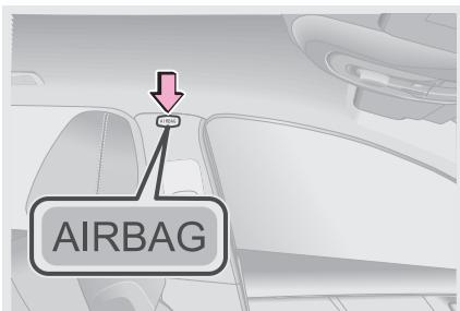
При боковом ударе, если соблюдены необходимые условия, срабатывает оконная шторка безопасности. В зависимости от того, в какую сторону автомобиля произошел удар, она защищает голову водителя и сидящего за ним заднего пассажира или переднего пассажира и сидящего за ним заднего пассажира.
