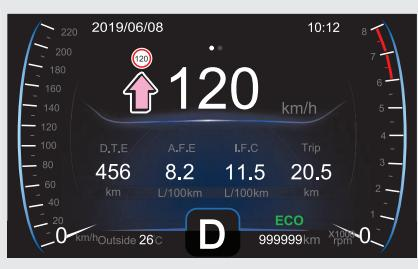
При достижении автомобилем заданной скорости движения на экране информации о вождении автомобиля загорается индикатор превышения скорости движения **(120)** с указанием ее величины, а также включается звуковая сигнализация. Индикатор превышения скорости движения выключается только после того, как скорость движения автомобиля опустится ниже заданной на 5 км/ч. Если после этого скорость еще раз превысит заданную, звуковая сигнализация включится снова.
