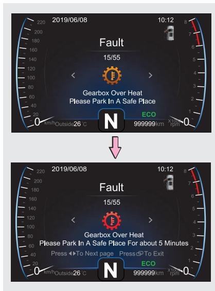
При перегреве коробки передач на приборной панели отображается предупреждение Gearbox Over Heat Please Park In A Safe Place (Перегрев коробки передач. Остановите автомобиль в безопасном месте).
