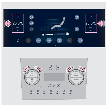
Задать нужную температуру воздуха можно регулятором температуры со стороны водителя/переднего пассажира на панели управления системой кондиционирования воздуха или сенсорными кнопками на дисплее.
