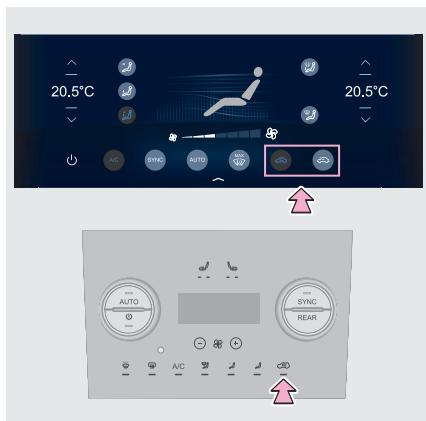
Включить и выключить режим рециркуляции воздуха можно соответствующей кнопкой на панели управления системой кондиционирования воздуха или сенсорной кнопкой на дисплее.
