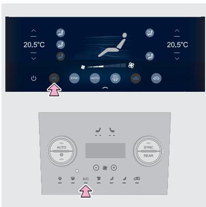
Включить систему кондиционирования воздуха можно соответствующей кнопкой на панели управления системой кондиционирования воздуха или сенсорной кнопкой на дисплее.
