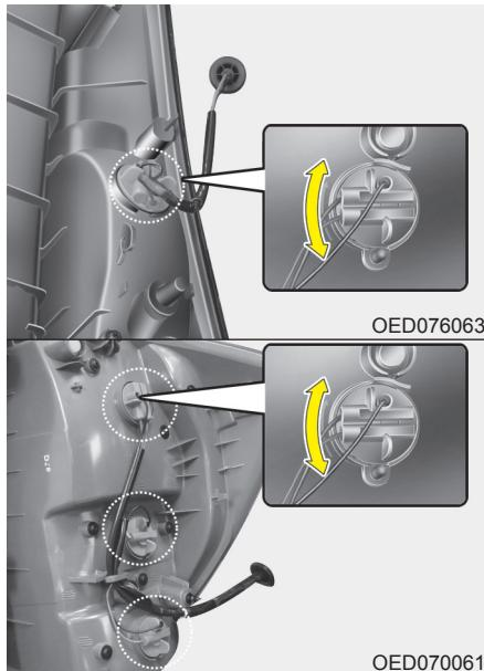
4. Выньте патрон из корпуса, поворачивая патрон против часовой стрелки до тех пор, пока ушки на патроне не совпадут с вырезами на корпусе.
