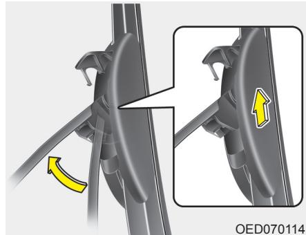
6. Установите щетку на место до щелчка фиксатора.
