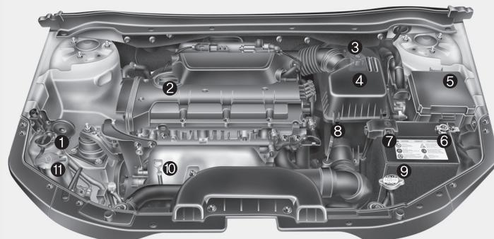
1. Бачок расширительный для охлаждающей жидкости
