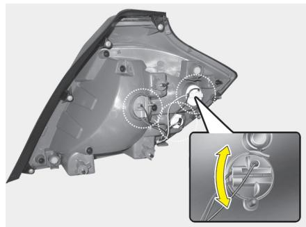
5. Снимите крышку и патрон из корпуса фонаря его поворотом против часовой стрелки, до совпадения выступов на крышке с канавкой на корпусе фонаря.
