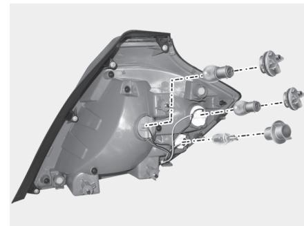
6. Снимите лампу из патрона нажатием и вращением до совпадения выступов на лампе с канавками на патроне. Вытяните лампочку из патрона.
