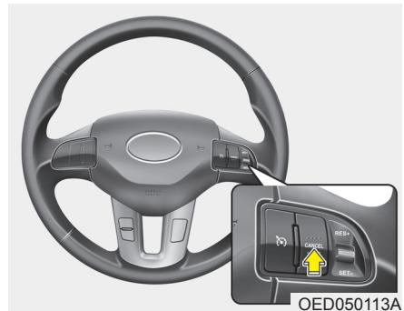
Каждое из этих действий приведет к отмене работы круиз-контроля (на приборной панели погаснет контрольная лампа *SET* (Установка)), но система при этом не отключится. Если Вы захотите возобновить работу круиз-контроля, нажмите выключатель *RES+*, находящийся на рулевом колесе. Произойдет возвращение к установленной ранее скорости.
