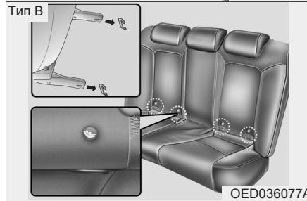
На нижней части задних сидений с обеих сторон расположены маркеры детских ремней безопасности, отмечающие места крепления нижних фиксаторов ремней безопасности для детей, установленных подобным образом.
