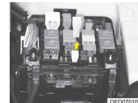
3. Извлеките сомнительный предохранитель, потянув его вверх, вертикально, под прямым углом к блоку предохранителей. Для извлечения предохранителей (плавких вставок) из блока в отсеке двигателя используйте приспособление, входящее в комплект поставки автомобиля.
