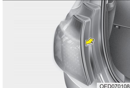
3. Ослабить стопорную гайку блока фар.
