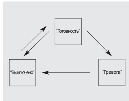
Эта система предназначена для защиты автомобиля от несанкционированного проникновения. В работе системы существуют три этапа: первый этап называется "Готовность", второй - "Тревога", третий этап - "Выключено". Во сработавшем состоянии система противоугонной сигнализации подает звуковой тревожный сигнал одновременно с миганием огней аварийной сигнализации.
