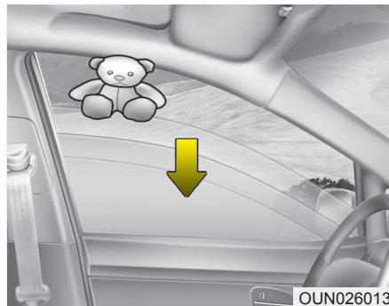
И если снова постоянно нажимать клавишу управления стеклоподъемником в течение 5 секунд после опускания стекла в результате автоматического обратного хода, функция автоматического обратного хода выполняться не будет.
