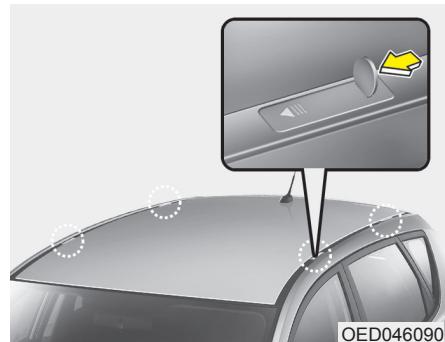
При использовании для открытия крышки ногтя пальца Вы можете серьезно повредить его. Для установки или снятия багажника на крыше можно использовать специальный крепежный кронштейн.
