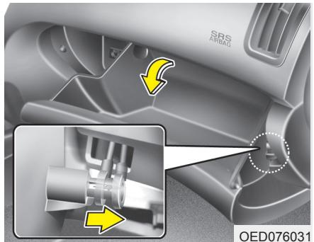
2. Приоткройте перчаточный ящик и, изнутри его, вытащите эластичный шнур, протолкните фиксатор через отверстие в боковой части перчаточного ящика. Дайте перчаточному ящику открыться.
