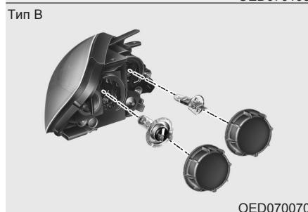
5. Снимите крышку лампы фары, повернув ее против часовой стрелки.
