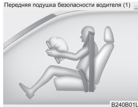
Модули подушек безопасности находятся в центре рулевого колеса и внутри передней панели напротив пассажирского сиденья над перчаточным ящиком. Когда блок SRSM определит наличие удара большой силы в переднюю часть автомобиля, он автоматически подаст команду на раскрытие подушек безопасности.
