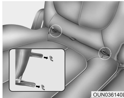
Оба задних боковых сиденья оборудованы парой креплений ISOFIX, а также соответствующими верхними креплениями на фале, прикрепленными к задней стороне задней стойки. Крепления ISOFIX расположены между спинкой сиденья и задней стойкой и обозначены пиктограммой ISOFIX.
