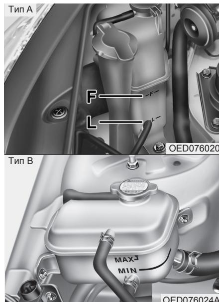
Проверьте состояние всех шлангов систем охлаждения и обогрева, а также их соединения. Замените все изношенные или имеющие вздутия шланги.
