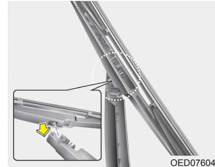
2. Установите новую щетку в сборе, вставляя центральную часть в отверстие на рычаге стеклоочистителя, пока не послышится щелчок.
