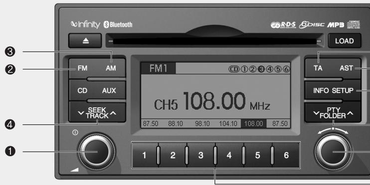
1. Кнопка ВКЛ./ВЫКЛ. питания и ручка регулировки громкости
