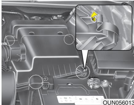
1. Отпустите защелки, крепящие крышку воздушного фильтра, и откройте крышку.
