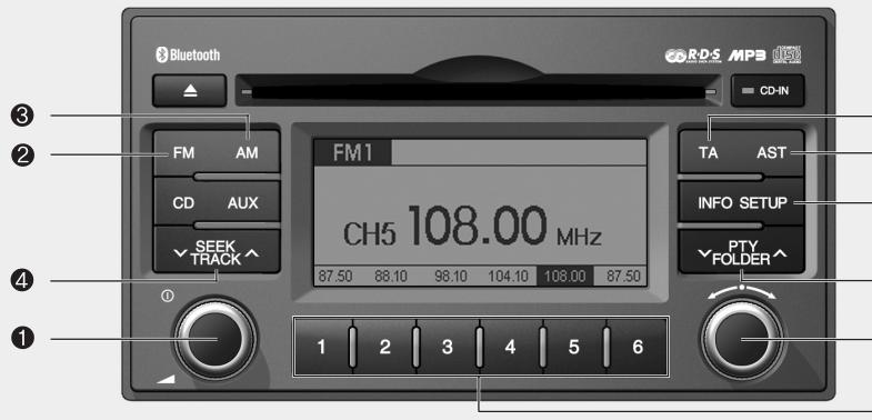
1. Кнопка ВКЛ./ВЫКЛ. питания и ручка регулировки громкости
