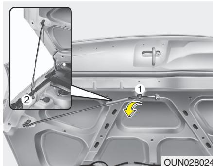
3. Выньте упор капота из места его крепления на капоте.
