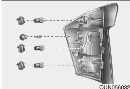
4. Отделите гнездо от деталей узла, вращая его против часовой стрелки, пока выступы на корпусе гнезда не совместятся с пазами в деталях узла.
