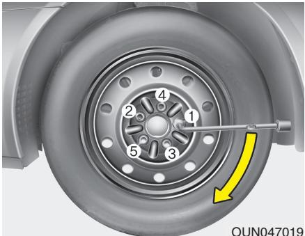
Затем установите ключ в соответствии с рисунком и затяните колесные гайки. Следите, чтобы торцевая насадка плотно обхватывала гайку (Тип А). Не вставайте на рукоятку ключа и не удлиняйте ее трубой. Пройдите колесо по кругу, затягивая каждую гайку, пока все не будут плотно затянуты. Затем дважды проверьте затяжку каждой гайки. После замены колес как можно скорее обратитесь к авторизованному дилеру компании KIA, чтобы затянуть колесные гайки на нужный момент.
