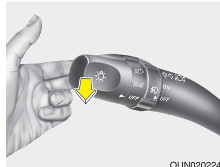
Для мигания дальним светом фар потяните рычаг на себя. При его отпускании рычаг вернется в нормальное положение (ближний свет). Для использования этой функции включение переключателя управления осветительными приборами не требуется.
