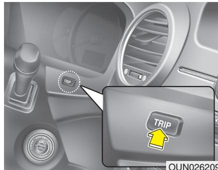
Выбор одометра поездки А или В производится путем нажатия на кнопку TRIP в течение менее 1 секунды.
