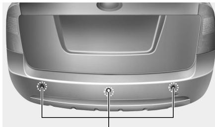
Система предупреждения о наличии препятствий позади автомобиля OUN027122
