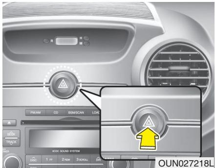
Для выключения аварийной сигнализации надо еще раз нажать на соответствующую кнопку.
