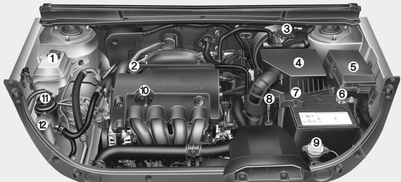
1. Расширительный бачок системы охлаждения двигателя ..... 7-22
