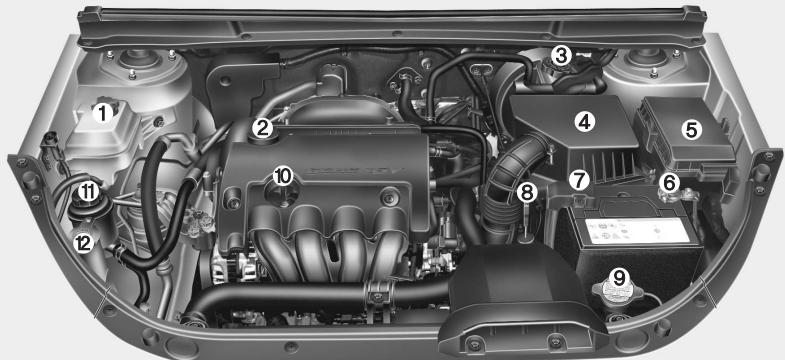
1. Расширительный бачок для жидкости системы охлаждения
