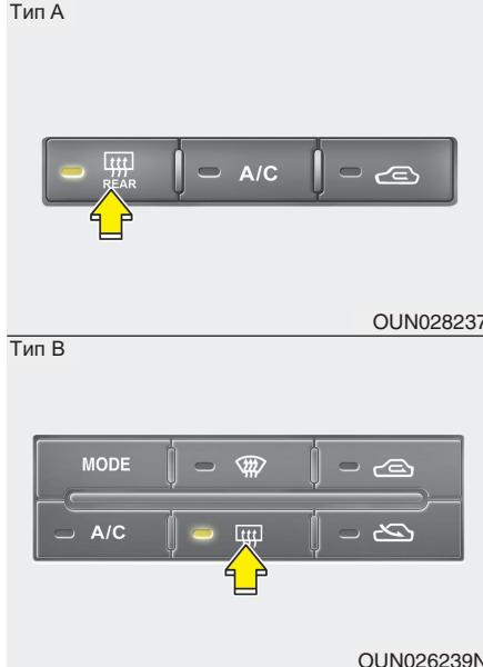
Для включения обогревателя заднего стекла нажмите соответствующую кнопку, расположенную на центральной панели переключателей. При включении обогревателя в этой кнопке загорится контрольная лампа. При наличии толстого слоя снега на заднем стекле удалите его щеткой перед включением обогревателя.
