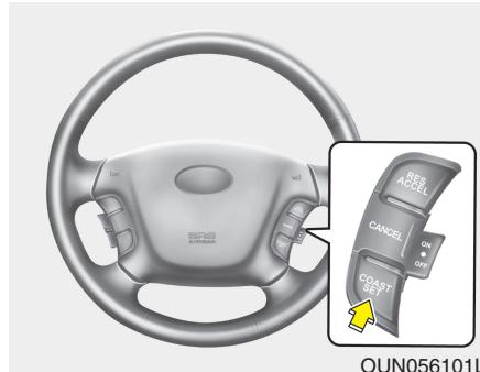
3. Нажмите выключатель COAST/SET (Накат/установка) и отпустите его на нужной скорости. На приборной панели загорится контрольная лампа SET (Установка). Одновременно с этим отпустите педаль газа. Желаемая скорость будет поддерживаться автоматически.
