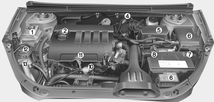
1. Расширительный бачок для жидкости системы охлаждения ..... 7-22
