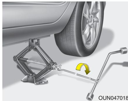
8. Вставив рукоятку домкрата и поворачивая ее по часовой стрелке, поднимайте автомобиль до тех пор, пока колесо не оторвется от земли.
