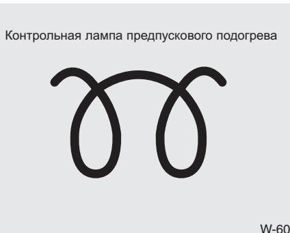
3. Для запуска двигателя поверните ключ зажигания в положение ON (Вкл.). Загорится контрольная лампа предпускового подогрева.
