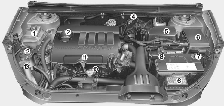
1. Расширительный бачок для жидкости системы охлаждения
