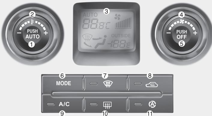
1. Кнопка включения автоматического режима
